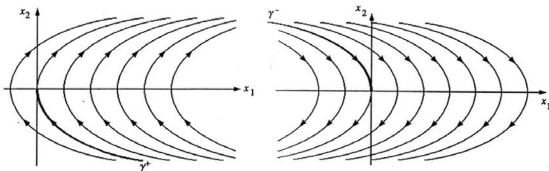
Si noti che le traiettorie convergono verso l'origine per gli archi di parabola rispettivamente indicati con  $\gamma^+$  (caso 1) e  $\gamma^-$  (caso 2). Solamente se lo stato iniziale è esattamente su uno di questi due archi di parabola, la legge di controllo sarà costante su tutto l'intervallo  $[0, t_f]$ , altrimenti ci sarà una commutazione dal caso 1 al caso 2 o viceversa.
