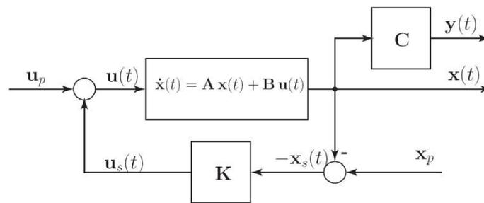
mette in evidenza lo stato "desiderato"  $x_p$ . In generale esso non è dato, ma viene fornito il vettore  $y_p$ . E' perciò conveniente calcolare il segnale di controllo  $u(t) = -Kx(t) + u_{ps}$ , definendo  $u_{ps}$  sulla base del set-point  $y_p$ .
