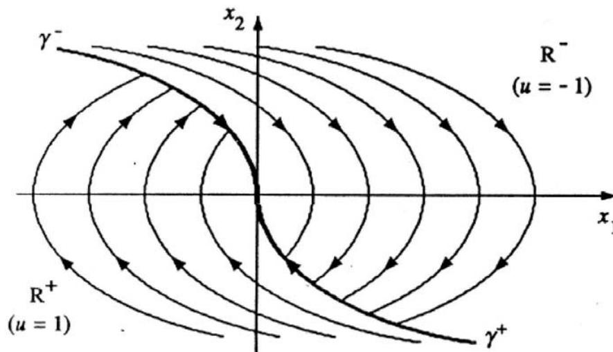
La regione  $R^+$  del piano contiene gli stati iniziali per i quali la legge di controllo deve assumere il valore iniziale  $u(t) = 1$  e poi commutare  $u(t) = -1$  una volta raggiunto l'arco  $\gamma^-$ . Vale il viceversa per la regione  $R^-$ .
