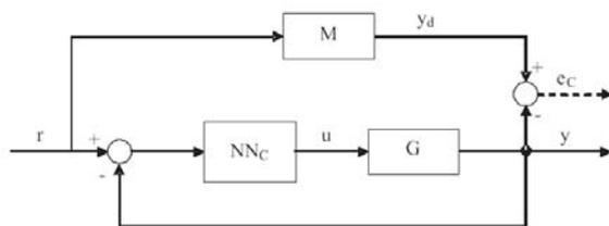
Figura 2: Controllo con modello di riferimento
