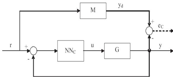
Figura 2: Controllo neurale con modello di riferimento
