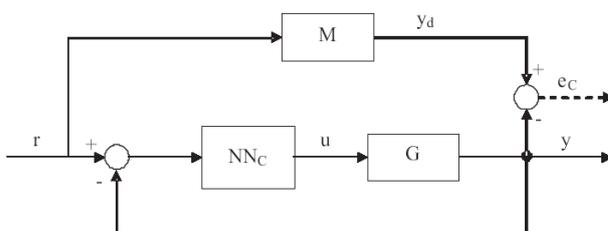
Figura 2: Controllo con modello di riferimento
