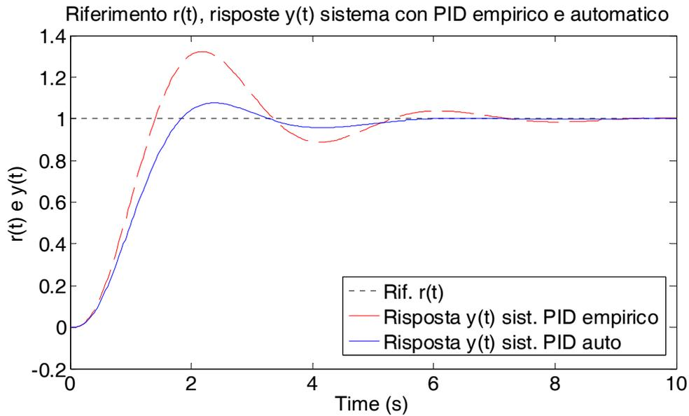
Si eseguono gli stessi confronti per i PID a tempo discreto i cui parametri sono gli stessi del PID a tempo continuo con taratura empirica, e quello i cui parametri sono calcolati con la procedura automatica di taratura eseguita dal blocco Simulink PID, però a tempo discreto.
