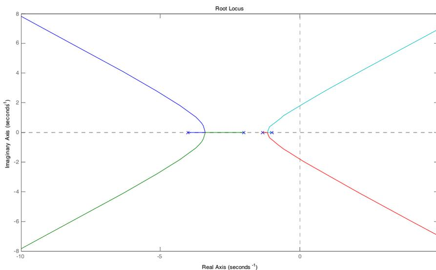
e col comando `rlocfind` si determina il guadagno  $K_c$  corrispondente ad uno dei due punti di intersezione dei due rami del luogo delle radici con l'asse delle ordinate, come rappresentato nell'ingrandimento della figura seguente.
