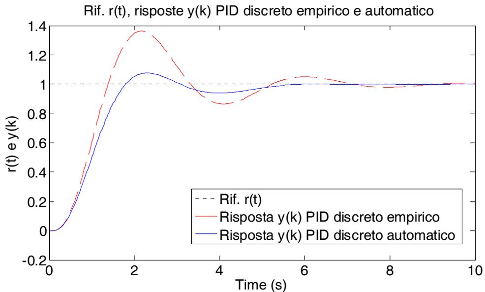
In questo caso risulta maggiormente evidente il miglioramento nella risposta del PID a tempo discreto i cui parametri sono stati ottimizzati con la procedura di taratura automatica, in cui infatti viene tenuto conto a priori della presenza del dispositivo di tenuta di ordine zero.
