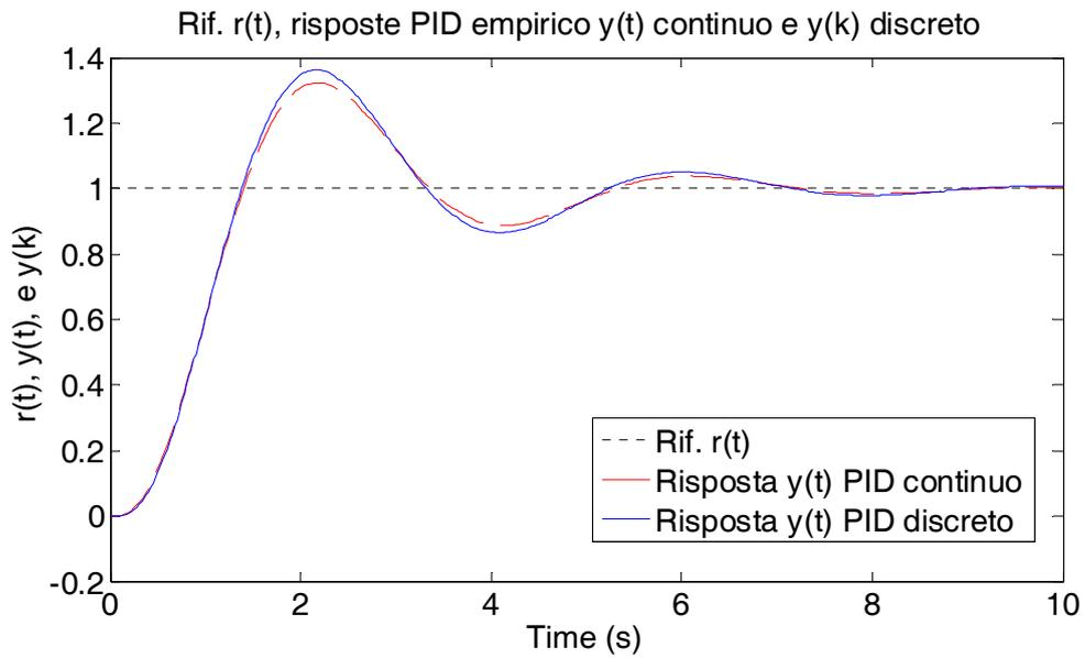
La differenza tra i regolatori PID continuo e discreto i cui parametri sono stati ottenuti dalle formule di Ziegler-Nichols appare evidente. L'inserimento del dispositivo di tenuta di ordine zero ha portato ad un lieve peggioramento delle prestazioni del sistema a tempo continuo, e in particolare ad un aumento, anche se limitato, della sovraelongazione.
