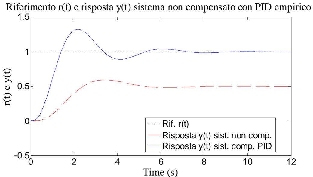
Si progetta successivamente il PID con taratura automatica, eseguita in maniera diretta dal blocco PID in Simulink a tempo continuo.
