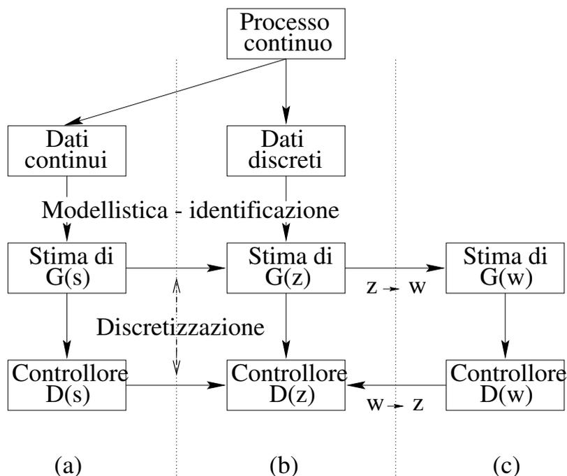
Figura 7.3: Quadro delle metodologie di progetto di un regolatore digitale.
