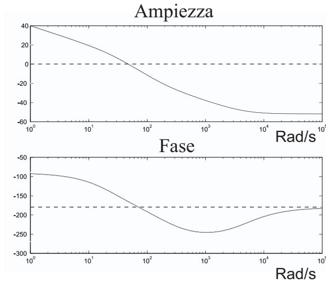
Figura 7.7: Diagrammi di Bode del sistema non compensato.
