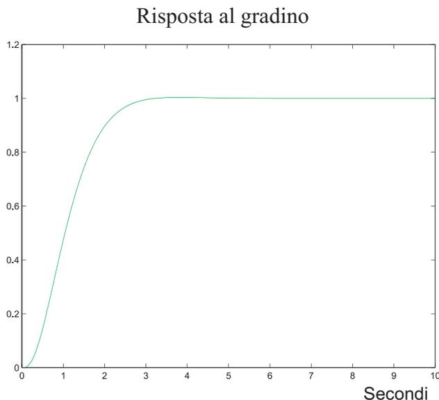
Figura 5.21: Risposta al gradino per la funzione  $KG_{c2}(s)G_p(s)$ .
