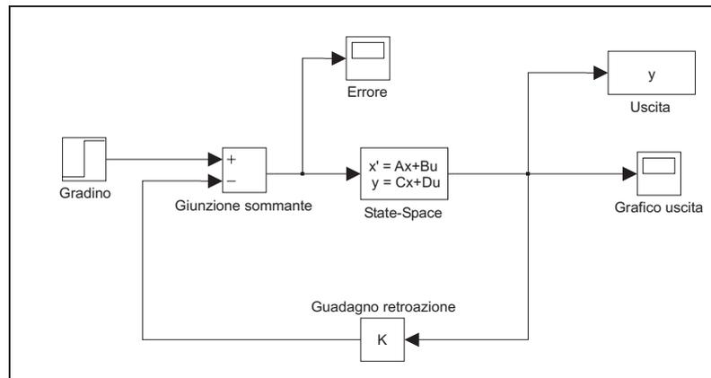
Figura 4.6: Sistema  $(A, B, C, D)$  chiuso in retroazione.
