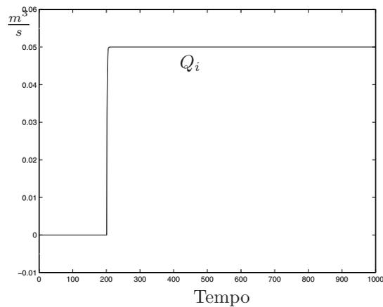
Figura 6.11: Portata in ingresso al serbatoio.
