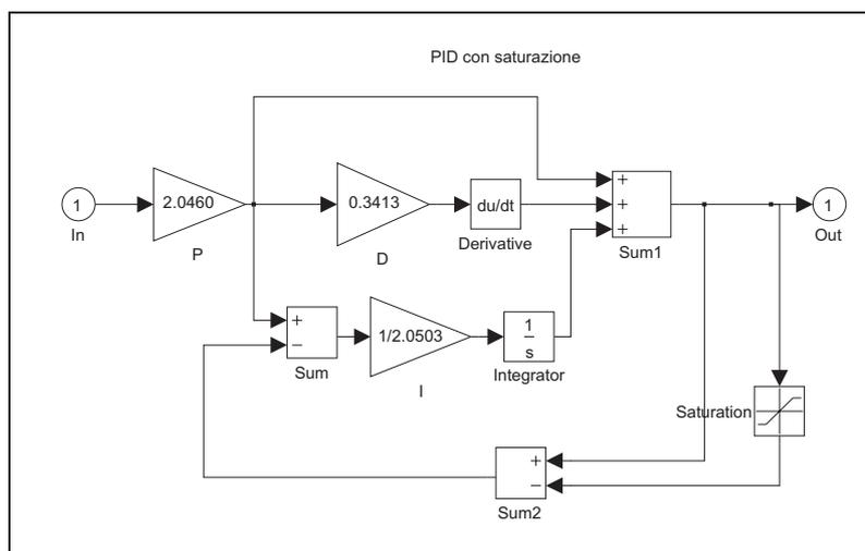
Figura 6.16: Subsystem PID con saturazione in ambiente *Simulink*.
