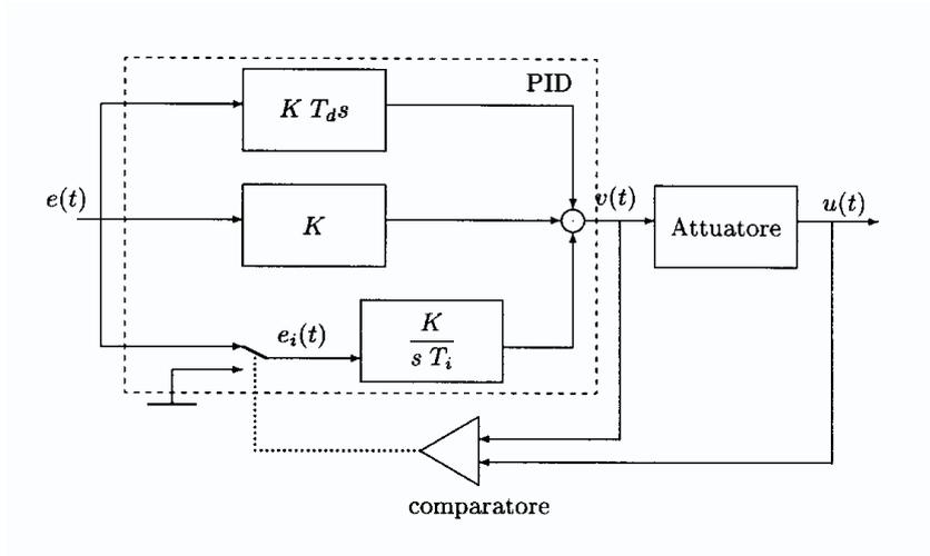
Figura 6.5: Schema di antisaturazione mediante integrazione condizionata.
