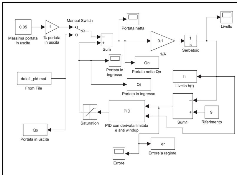
Figura 6.21: Schema *Simulink* di PID modificato e serbatoio.
