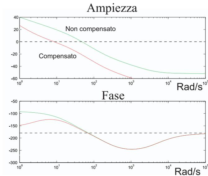
Figura 7.8: Diagrammi di Bode del sistema compensato e non compensato.
