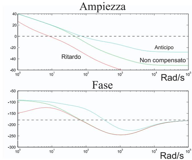
Figura 7.10: Diagrammi di Bode del sistema con rete anticipatrice, rete ritardatrice e senza compensazione.
