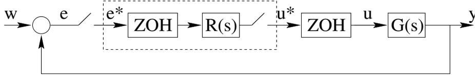
Figura 7.2: Schema equivalente del sistema di controllo digitale ottenuto con HE.
