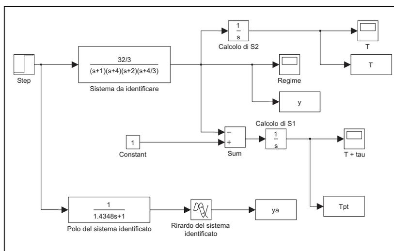
Figura 6.14: Modello *Simulink* per l'identificazione di  $G(s)$ .
