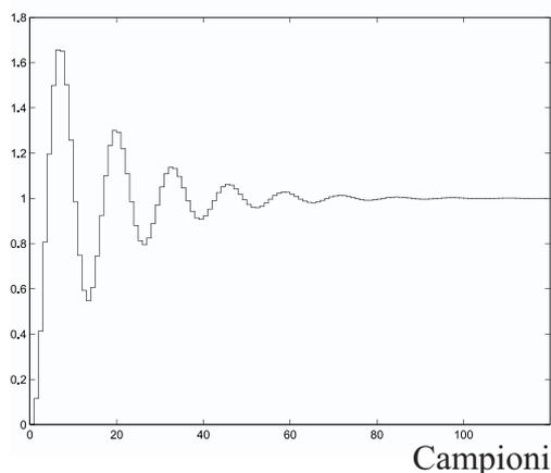
Figura 7.6: Risposta al gradino del sistema non compensato.
