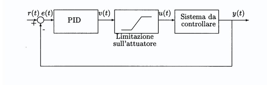
Figura 6.3: Schema a blocchi di un sistema di controllo con limitazione sull'attuatore.
