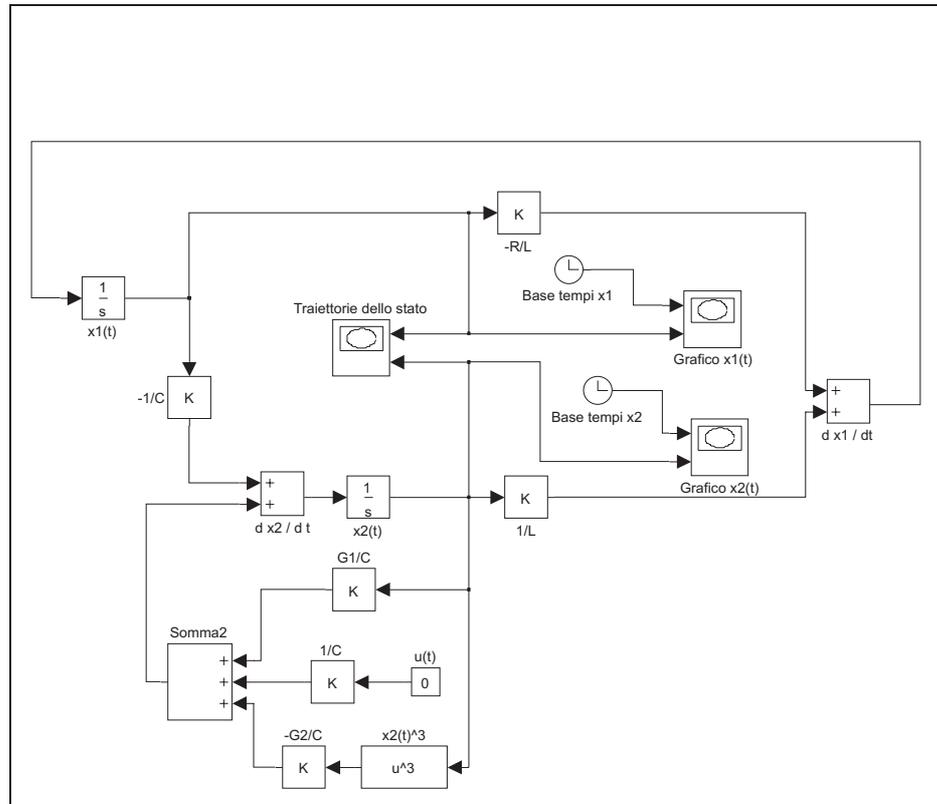
Figura 2.8: Circuito non lineare in *Simulink*.
