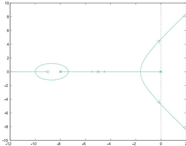
Figura 5.19: Luogo delle radici della funzione  $G_{c2}(s)G_p(s)$ .
