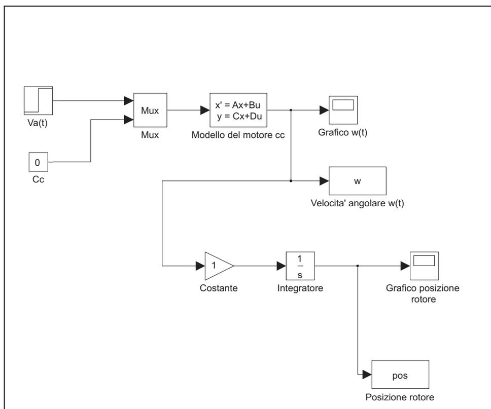
Figura 2.12: Modello *Simulink* del motore in corrente continua.
