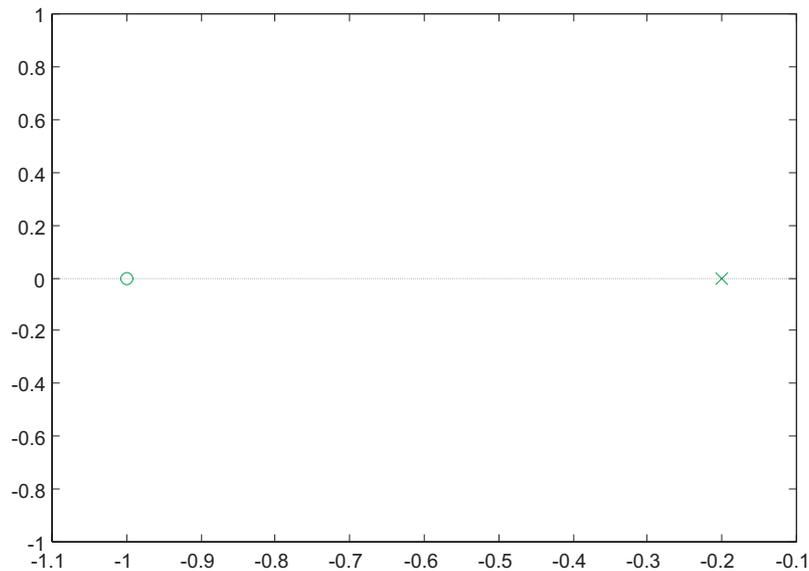
Figura 5.1: Polo ( $\times$ ) e zero ( $\circ$ ) della funzione  $g$ .
