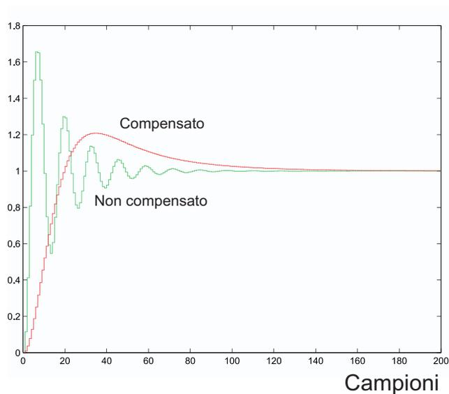
Figura 7.9: Risposta del sistema con e senza compensazione.
