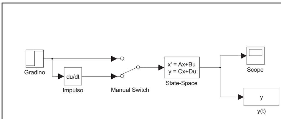
Figura 5.1: Schema a blocchi del sistema (A,B,C)
