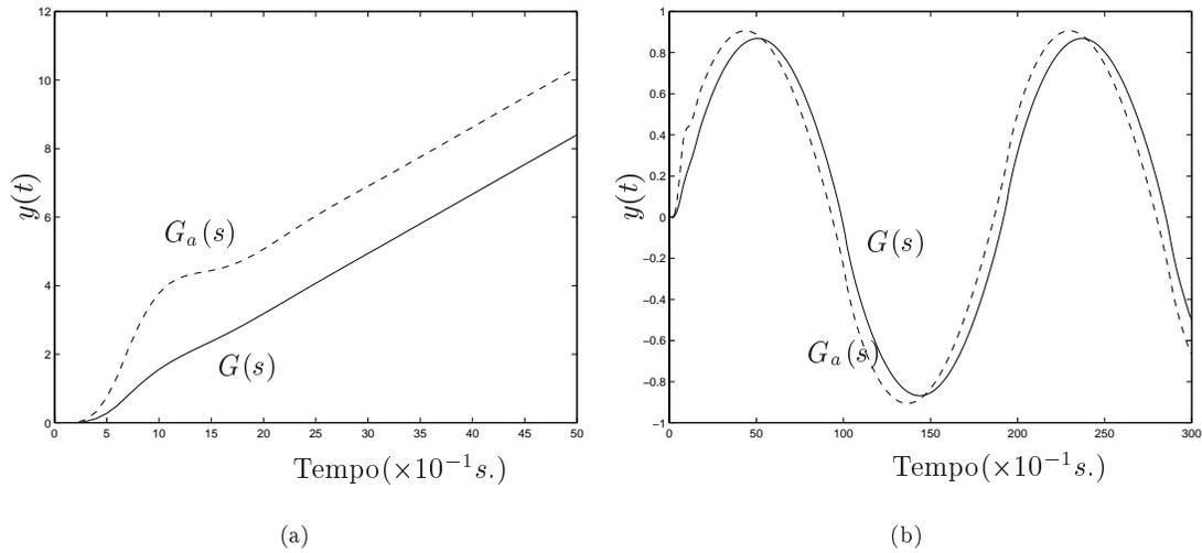
Figura 5.6: Risposte alla rampa (a) e alla sinusoide (b) dei sistemi  $G(s)$  e  $G_a(s)$
