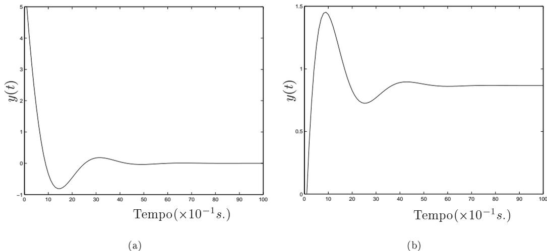
Figura 5.2: Risposte all'impulso (a) e al gradino (b) del sistema (A,B,C)
