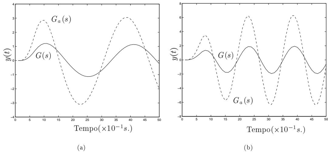
Figura 5.7: Risposte ad una sinusoide con frequenza 1 rad/s (a) e 2 rad/s (b).
