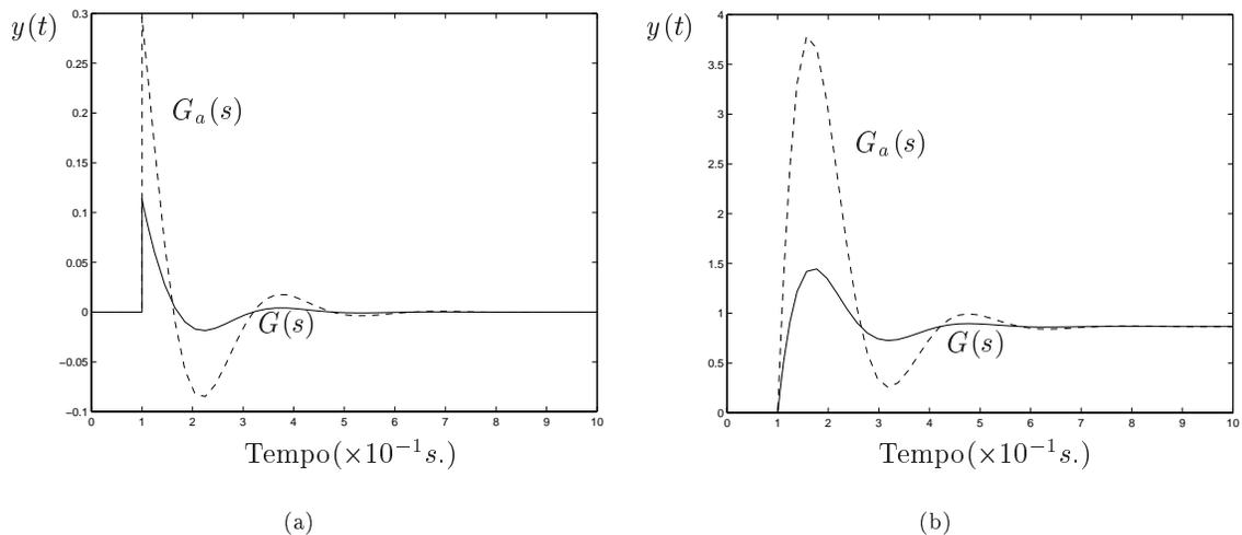
Figura 5.4: Risposte all'impulso (a) e al gradino (b) dei sistemi  $G(s)$  e  $G_a(s)$
