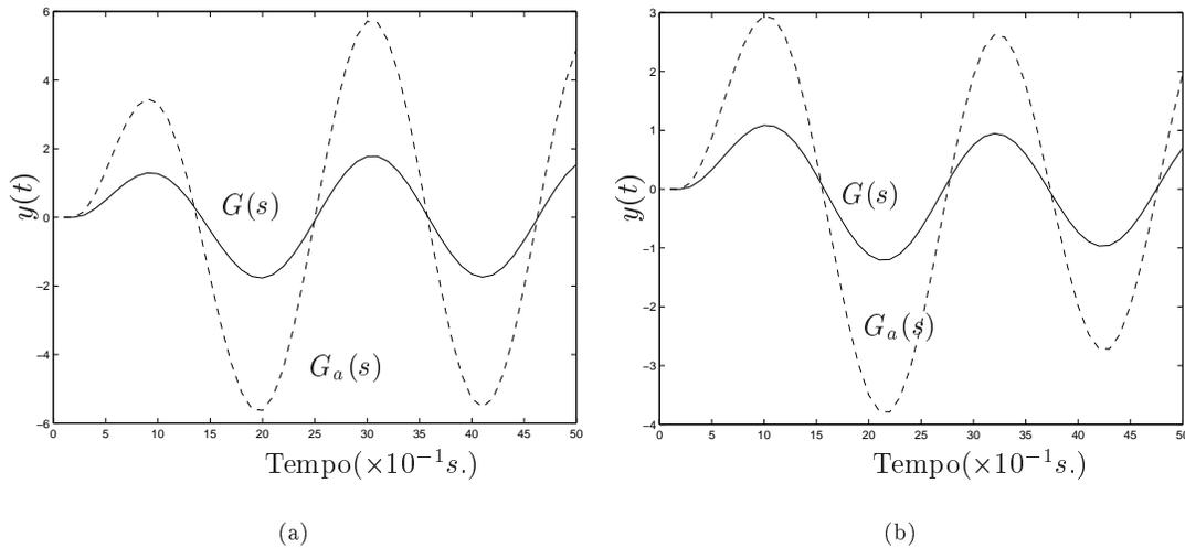
Figura 5.8: Risposte ad una sinusoide con frequenza 3 rad/s (a) e 5 rad/s (b).
